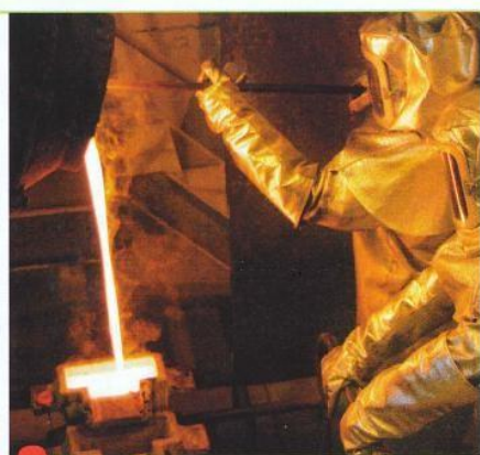
3 Coulée d'aluminium liquide. L'aluminium passe à l'état liquide à 660 °C.
